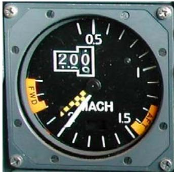
Les index mobiles de couleur jaune sur le machmètre indiquent aux pilotes la plage de vitesses utilisables compte-tenu du centrage instantané de l'avion. L'aiguille à damier indique pour sa part le Mach à ne pas dépasser.
